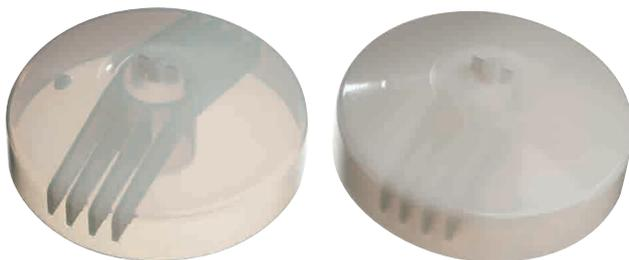
Abb. 2: Vergleich der Trübung zweier Testkörper aus Ultramid® Vision (links) und Standard-PA6 (rechts)
